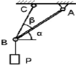
2. Груз весом  $P = 10 \text{ Н}$  подвешен на двух тросах  $AB$  и  $BC$ , составляющих с горизонтальной прямой углы  $\beta = 15^\circ$  и  $\alpha = 30^\circ$ . Определить усилия в тросах.
